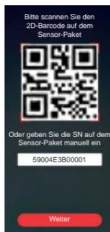
Befolgen Sie Schritt 4 aus Abschnitt 2.1.2 und scannen Sie den SN-2D-Barcode auf dem Sensor-Pack-Etikett oder geben Sie den vollständigen SN-Code vom Sensor-Pack manuell ein. Der SN-Code ist für jeden Sensor und Transmitter einzigartig. Stellen Sie sicher, dass Sie den richtigen Code eingeben. Wenn Sie den falschen Code oder einen Code aus einer anderen Sensor Verpackung eingeben, können Sie das iCan CGM nicht verwenden und Ihre Glukoseergebnisse könnten inkorrekt sein.
